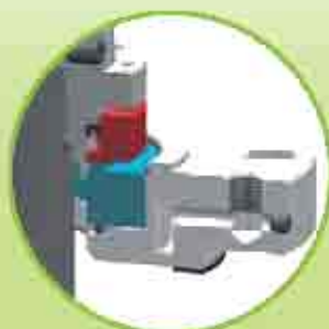
Flangia con camera di raffreddamento (C)
